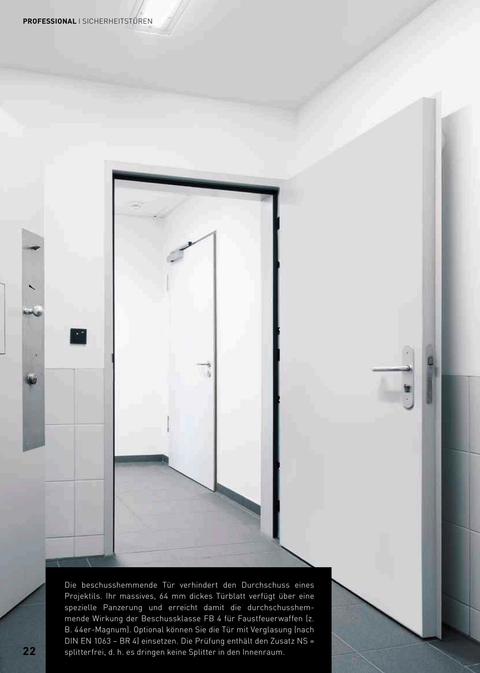
Die beschusshemmende Tür verhindert den Durchschuss eines Projektils. Ihr massives, 64 mm dickes Türblatt verfügt über eine spezielle Panzerung und erreicht damit die durchschusshemmende Wirkung der Beschussklasse FB 4 für Faustfeuerwaffen (z. B. 44er-Magnum). Optional können Sie die Tür mit Verglasung (nach DIN EN 1063 – BR 4) einsetzen. Die Prüfung enthält den Zusatz NS = splitterfrei, d. h. es dringen keine Splitter in den Innenraum.
