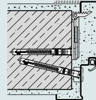
Schnelle und verdeckte Montage der Umfassungszarge mithilfe von Justierschrauben und Aufschiebeanker
