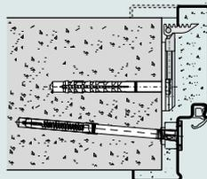
Schweißmontage mit Ankerbügel (Porenbeton)
