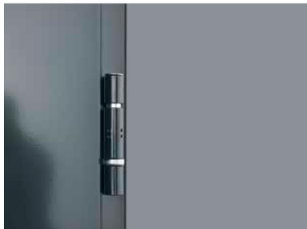
**Ko-Band:** Konstruktionsbänder mit Kugellager garantieren das dauerhaft leichte Öffnen und Schließen der Tür. Die Bänder sind dabei so in das Türblatt integriert, dass die Türblattoberfläche optisch nicht beeinträchtigt wird. Die Türen können nachträglich über die mitgelieferten Fitschenringe bis zu 4 mm höhenverstellt werden.
