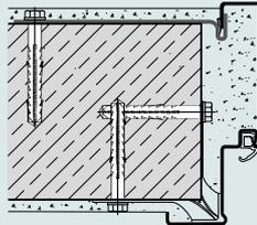
Dübel- und Klappanker- montage (Mauerwerk / Beton)
