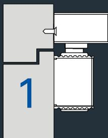
Die Direktmontage ist die Standard Montageart bei ECO. Die Gleitschiene wird direkt auf die Zarge montiert. Dazu müssen die ECO Befestigungsbohrungen vorgerichtet werden. Die entsprechenden Bohrungen sind auf den folgenden Seiten dargestellt.
