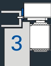
Das Adoptionsprofil (ADP 30) wird verwendet, wenn die Zargenkonstruktion eine stabile Befestigung der Gleitschiene nicht zulässt, z.B. bei Stahlzargen mit überfälzten Türen. Das Adoptionsprofil wird direkt auf die Zarge montiert. Die Gleitschiene kann jetzt stabil auf dieses ADP montiert werden. Es ist als Zubehör separat zu bestellen.
