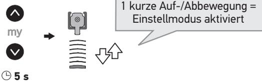
**2** Halten Sie die Taste ▲ gedrückt (1 kurze Bewegung) und drücken Sie bei Annäherung an die Endlage die Taste my, um den Antrieb zu stoppen. Drücken Sie dann mehrmals kurz die Taste ▲, bis die gewünschte obere Endlage erreicht ist:
