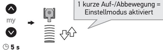
**2** Halten Sie die Taste ▼ gedrückt (1 kurze Bewegung) und drücken Sie bei Annäherung an die Endlage die Taste my, um den Antrieb zu stoppen. Drücken Sie dann mehrmals kurz die Taste ▼, bis die gewünschte untere Endlage erreicht ist:
