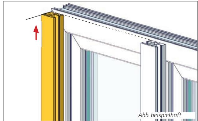
5. Aufgeklipste Rollladenführung/Aufbauprofil in die endgültige Position schieben.
