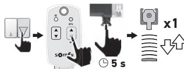
2 Um die Empfindlichkeit der Hinderniserkennung zu erhöhen, drücken Sie , um sie zu reduzieren bzw. die Funktion zu deaktivieren, drücken Sie .
