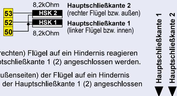
D.h.: Kontaktleisten im Modus „links/rechts“, die am linken (rechten) Flügel auf ein Hindernis reagieren sollen, müssen (in Serie) an den Anschlussklemmen der Hauptschließkante 1 (2) angeschlossen werden.
