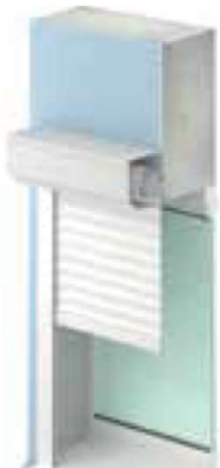
Hinter der Öffnung (auf der Wand)
