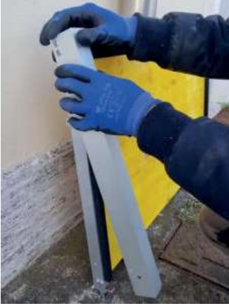
1 Beide Eckwinkel an den Seitenwinkel stecken und einrasten lassen.
