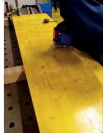
3 Schneiden Sie die Schalttafel entlang der gezeichneten Linie.
