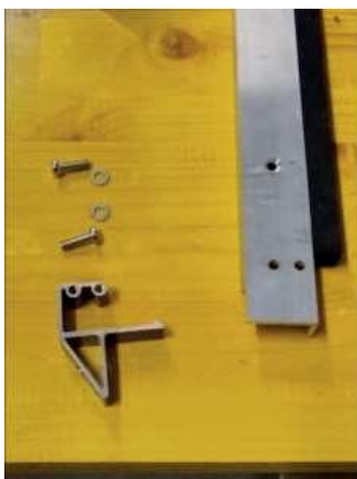
4 Die Befestigungshaken an den Seitenwinkeln montieren.
