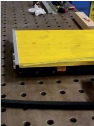
19 Messen Sie die erforderliche Dichtungslänge zwischen den beiden Seitendichtungen
