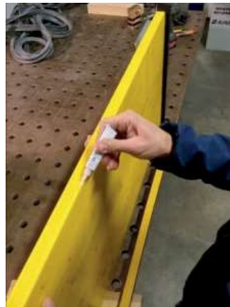
23 Zwei Linien Kleber auf die Schalttafel auftragen.
