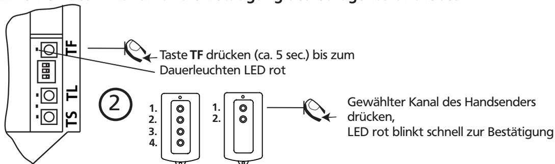
**3 Einlernen des 2. Kanals für die Betätigung des Lichts oder der Teilöffnung**
