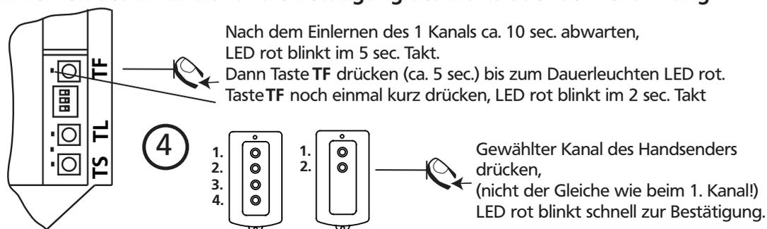
**5 Verlassen des Lernens erfolgt automatisch innerhalb von 10 sec., wenn kein weiterer Kanal eingelernt wird !**
