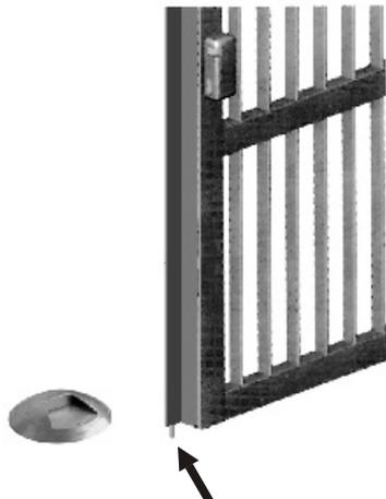
Beim Drehtor ist es erforderlich, an einem oder an beiden Flügeln ein Rundrohr (Ø20mm), das dann beim Schließen des Tores vom Anschlag aufgenommen wird, anzubringen.
