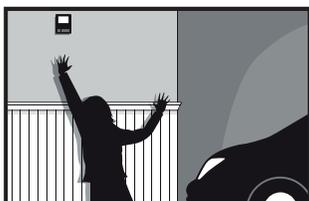
Der an der Wand montierte Drucktaster sollte sich außerhalb der Reichweite von Kindern befinden, mindestens in einer Höhe von 1,5 m und nicht in der Nähe von beweglichen Teilen sein. Montieren und verwenden Sie den Taster so, dass Sie das Schließen des Garagentores einwandfrei sehen können.
