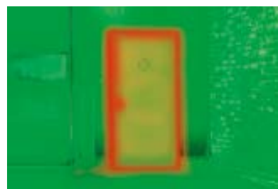
Sichtbarer Energieverlust ohne thermisch getrennte Tür
