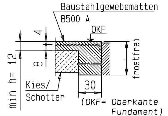
Betondeckung  $c_{\min} = 4,0\text{cm}$
