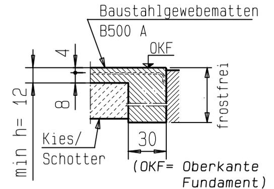
Betondeckung  $c_{\min} = 4,0\text{cm}$
