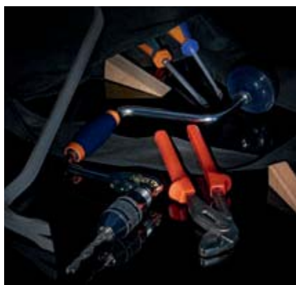
Abbildung rechts: Einbruchswerkzeug nach RC 3 Sicherheitsklasse
