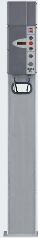
Optional: Standsäule STI 1 zur Montage von max. 2 Steuerungen mit Zusatz- gehäuse, Farbe: Weißaluminium, RAL 9006, Abmessungen: 200 x 60 mm, Höhe 1660 mm
