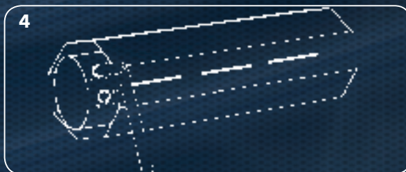
4 Start- und Stopppunkte für „Auf“ und „Ab“ einstellen
